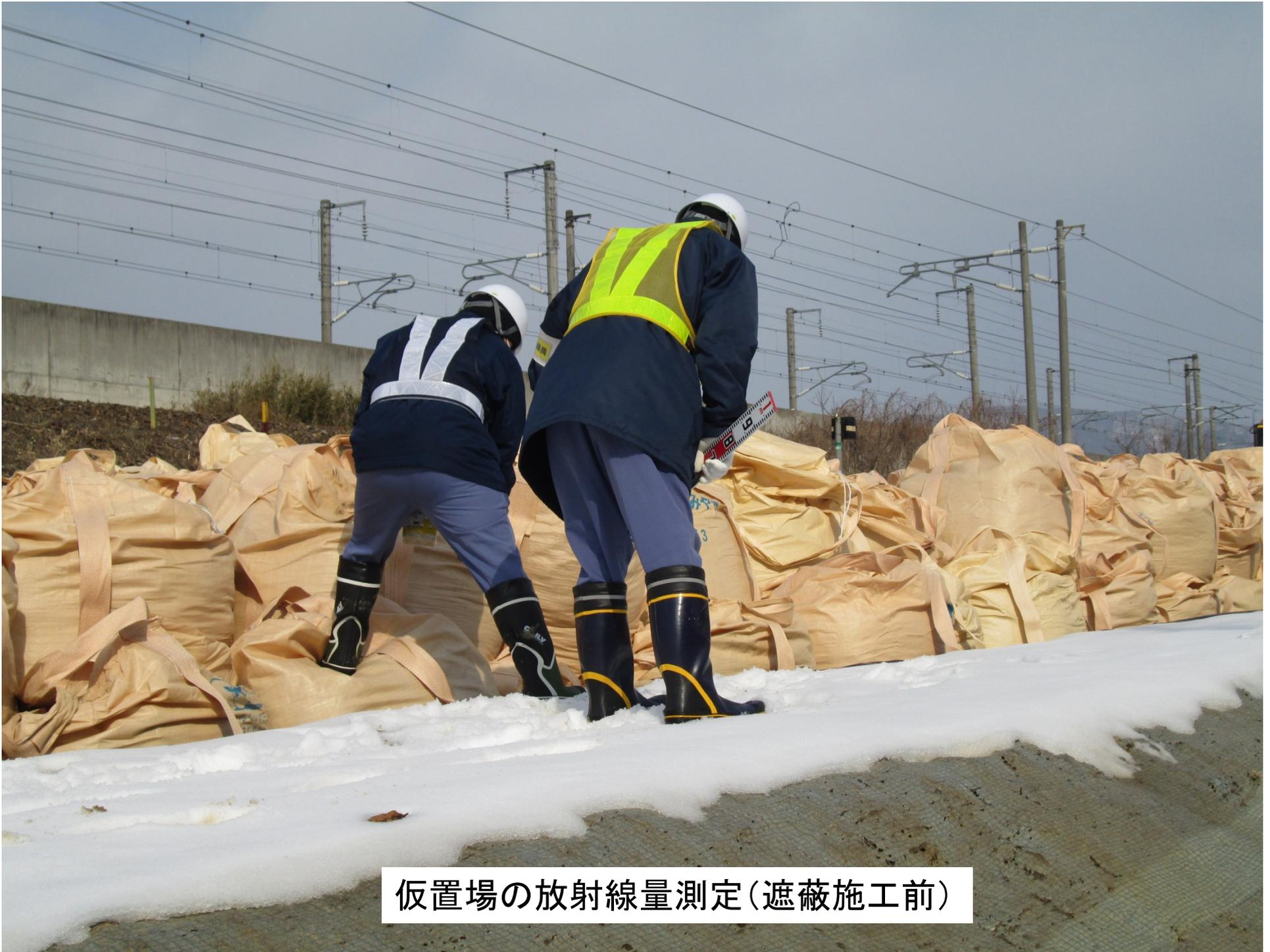
仮置場の放射線量測定(遮蔽施工前)
