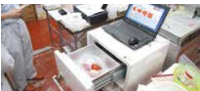
丸ごと食品中の放射能濃度を測定できる検査器
