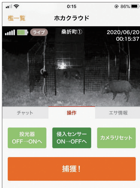
専用アプリでイノシシの動きを24時間監視 「捕獲」ボタンを押すと、おりが閉まる仕組み
