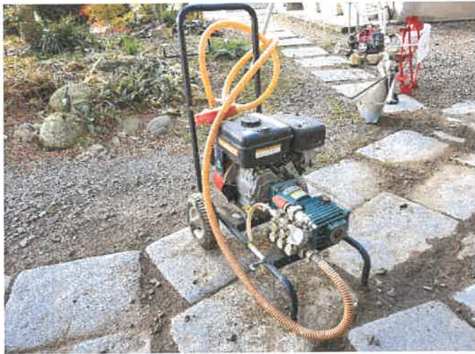
R6-05 高圧洗浄機 (樹皮削り)
