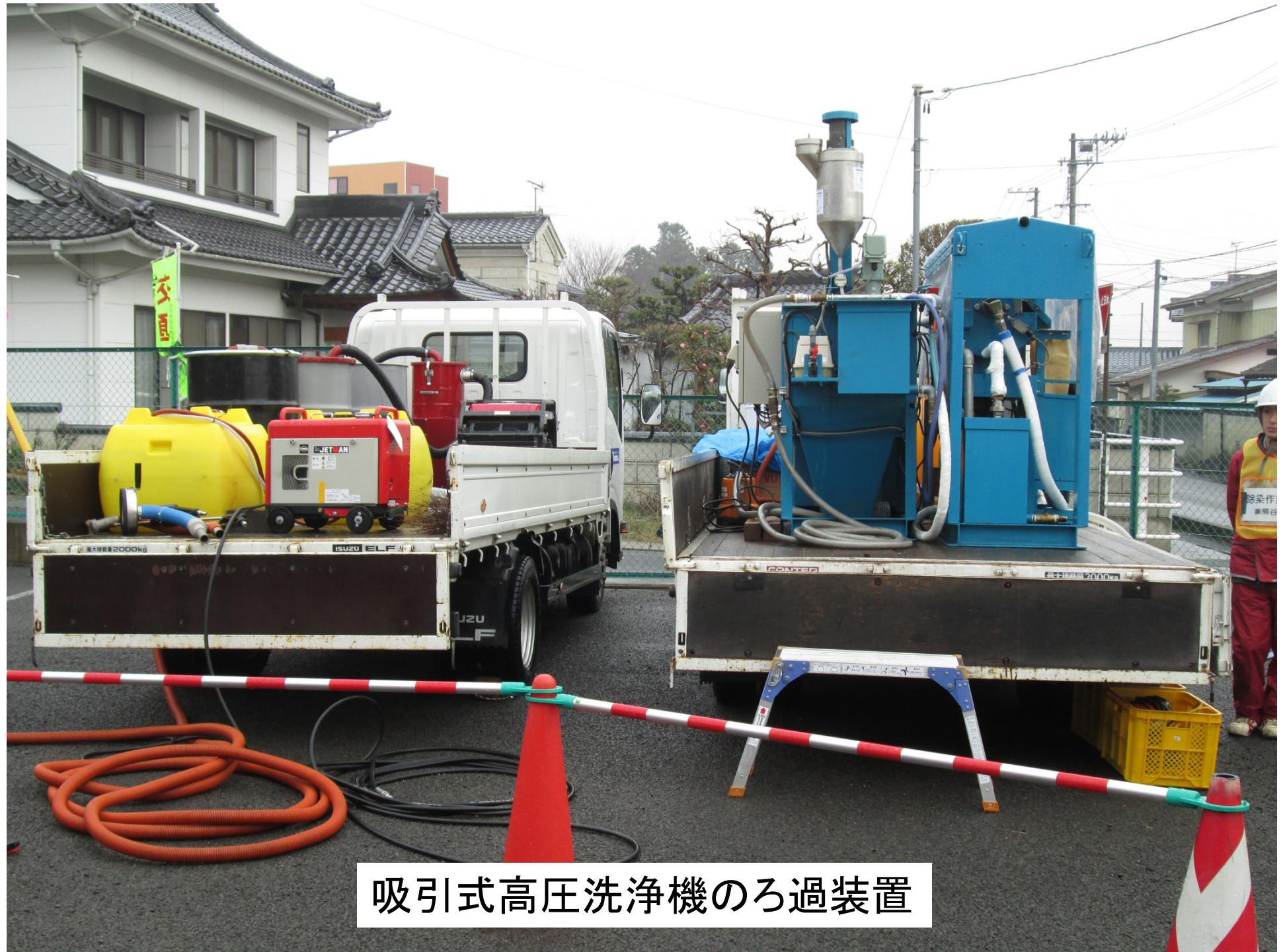
吸引式高圧洗浄機のろ過装置
