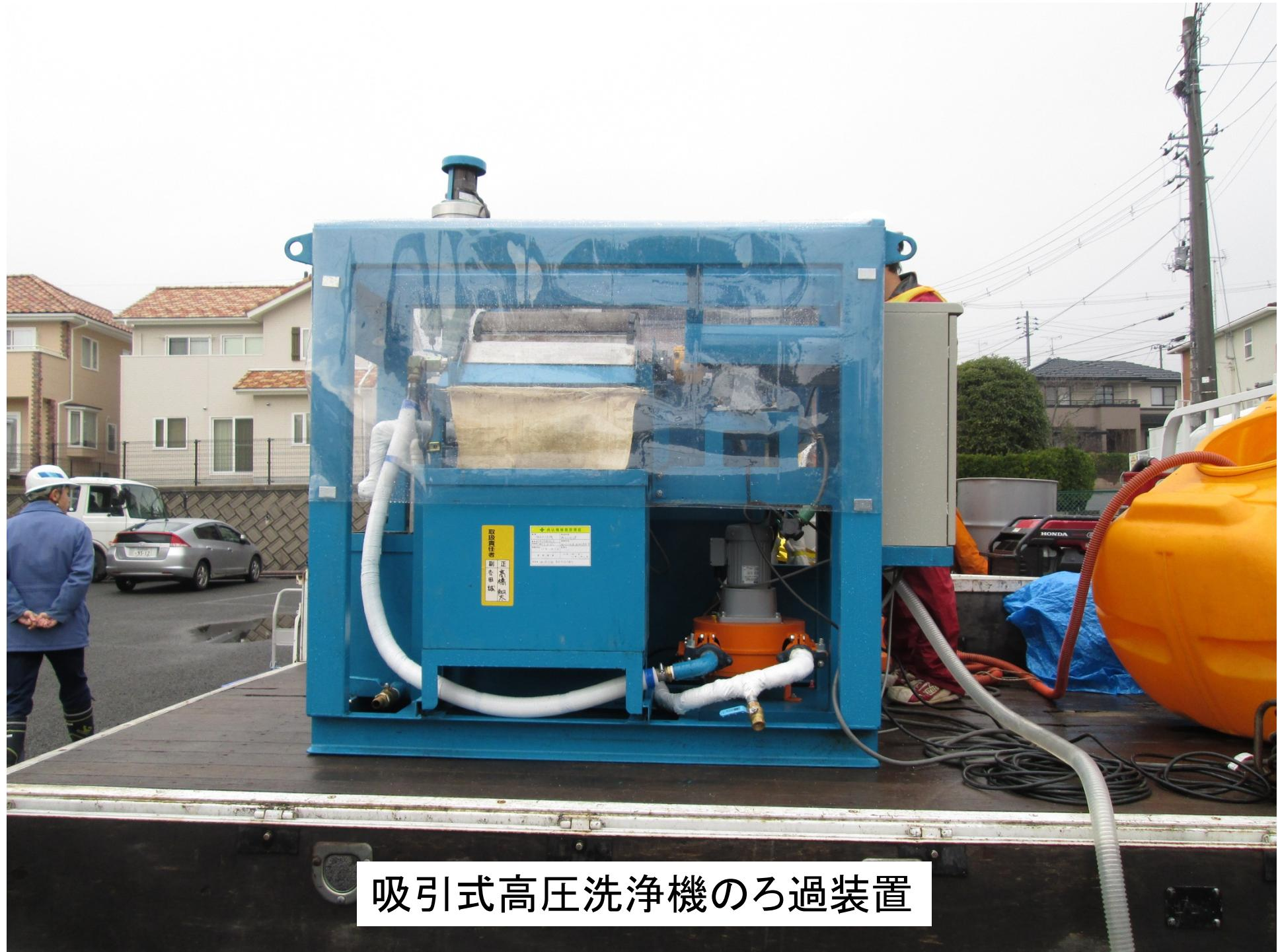
吸引式高圧洗浄機のろ過装置
